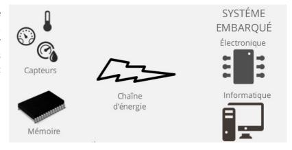
Les systèmes embarqués utilisent généralement des microprocesseurs à basse consommation d'énergie, ou des microcontrôleurs.
